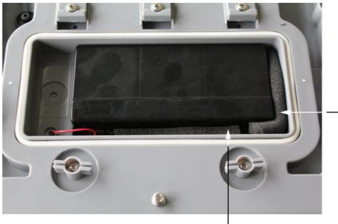
⇒ Inserire l'accumulatore in modo che non possa scivolare (bloccarlo con gli elementi in schiuma).
