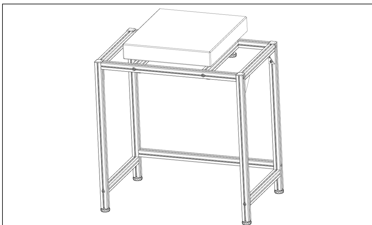
Rys. 6 Zmontowana rama wewnętrzna z blokiem granitowym
