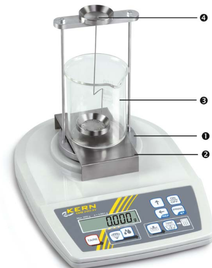
Fig. 1: Bilancia KERN EMB 200-3V con il kit per la determinazione di densità KERN YDB-01 KERN YDB-01 installato (per codici vedi il cap. 1)
