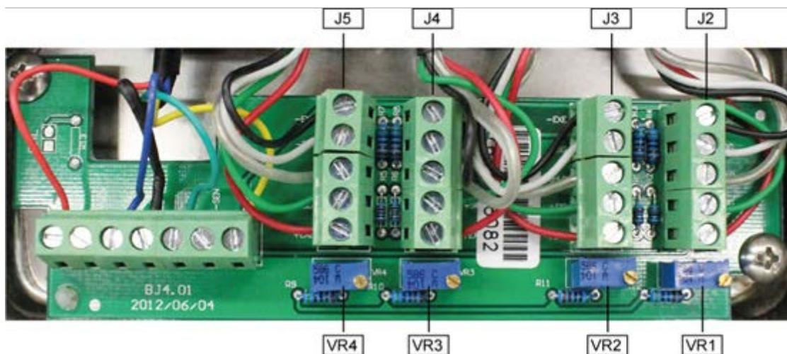
Ajustamento da célula de pesagem 3 realiza-se de potenciômetro VR1.
