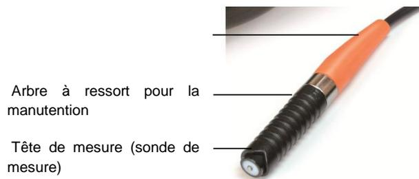
La sonde doit être touchée au niveau du segment inférieur de l'arbre et n'est que légèrement pressée sur l'objet à tester.
