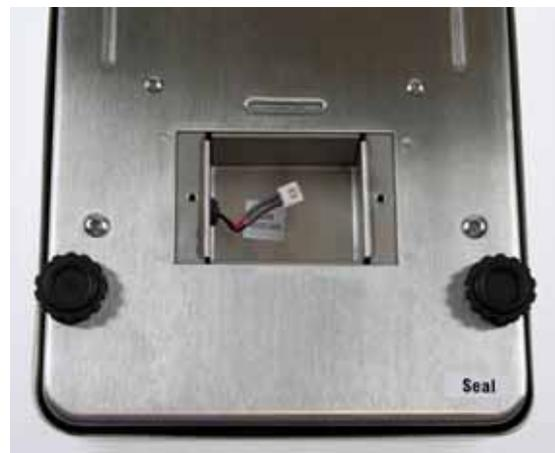
⇒ Enchufar el conector del bloque de acumuladores con el conector de la balanza
