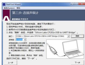
**Passo 3:** Collegare il fonometro e il computer secondo la richiesta dell'utente. Si noti che il fonometro richiede un'alimentazione esterna. Se il driver funziona correttamente, selezionerà automaticamente il **connettore CP210x**. Il valore predefinito per il **baud rate** è 115200 bps, a seconda del computer. Con un **baud rate** più alto la procedura di aggiornamento può essere accelerata.
