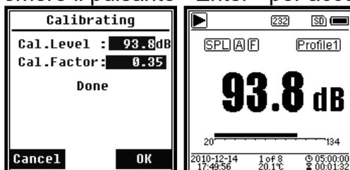
6. Tornare alla **schermata principale** e premere <Start/Stop> per **iniziare** la misurazione. Il risultato della misurazione attuale in questo esempio è 93,8 dB se il calibratore è in buone condizioni.
