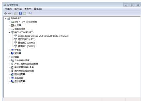
Dopo aver installato il driver, collega il fonometro al computer con un cavo USB. In Gestione periferiche, troverai un nuovo dispositivo chiamato **Silicon Labs CP210x USB to UART Bridge (COMx)**.
