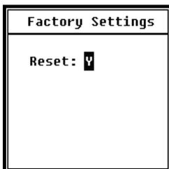
Le **impostazioni di fabbrica** offrono la possibilità di ripristinare tutti i parametri che sono stati modificati dagli utenti alle impostazioni di fabbrica. I parametri sono inizializzati con i valori di default. Usare i tasti freccia <◀>, <▶> per selezionare Y (Sì) o N (No). Se si seleziona **Y** (Yes) e si **preme** il tasto <Enter>, il parametro verrà inizializzato. Se si seleziona **N** (No) o si preme il **tasto ESC**, il reset sarà annullato.
