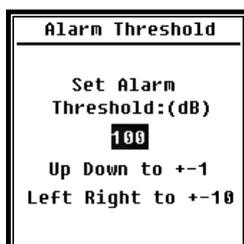
Se i risultati di misurazione dei profili 1 - 3 superano la **soglia di allarme**, il LED sopra <Power> si illumina di rosso. La soglia di allarme può essere impostata tra 20 dB e 200 dB. Usare i tasti freccia <▲>, <▼> per aumentare o diminuire la soglia di allarme di 1 dB. Usare i tasti freccia <◀>, <▶> per **aumentare o** diminuire l'impostazione di 10 dB.
