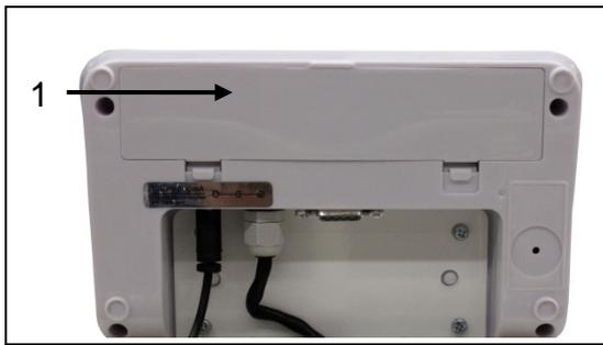
Abrir la tapa del compartimiento de batería (1) en la base del panel de control y conectar la batería. Antes de la primera utilización, recomendamos carguen la batería durante como mínimo 12 horas.
