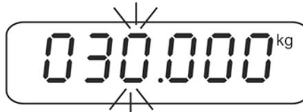
⇒ Entweder angezeigtes Justiergewicht verwenden oder mit den Navigationstasten ändern (numerische Eingabe, s. Kap. 3.1). Mit
