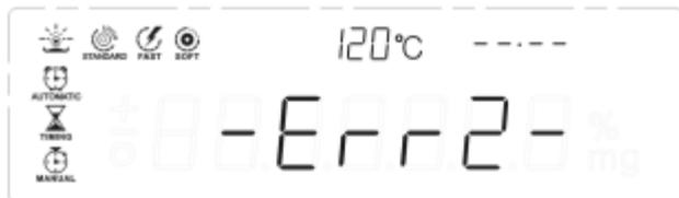
Err-2 : Température de séchage trop basse; réglez la température > 40 ° C.
