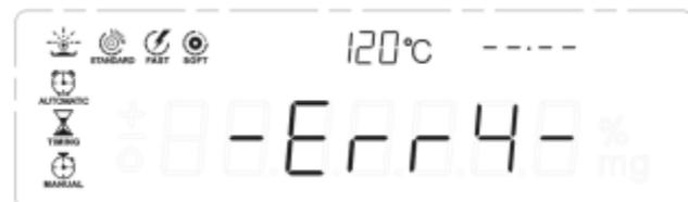
Err-4 : Problème de tension de la lampe halogène.
