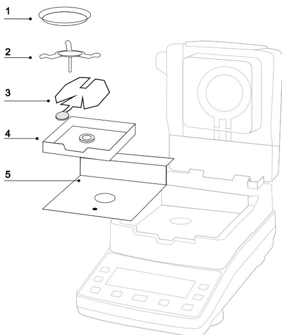
Ouvrir la cloche chauffante et retirer et nettoyer toutes les pièces dans l'ordre. N'utiliser pas de produits de nettoyage agressifs (dissolvants ou produits similaires) mais uniquement un chiffon humidifié de lessive douce de savon. Veillez à ce qu'aucun liquide ne pénètre au sein de l'appareil. Essuyer à l'aide d'un chiffon doux sec.
