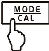
Con questa funzione viene memorizzato il peso di un contenitore della tara. Anche dopo l'inserimento/disinserimento la bilancia continua a lavorare con il valore tara memorizzato.
