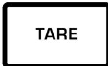
⇒ Waage entlasten und
