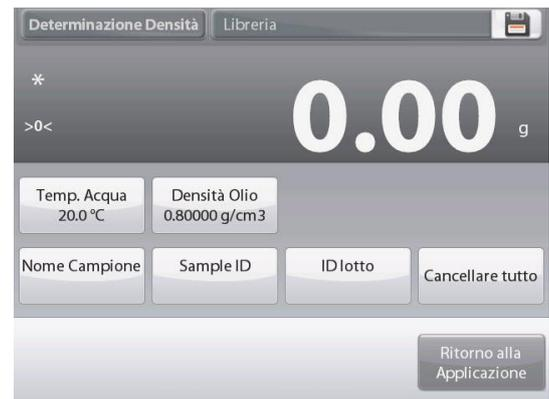
La bilancia calcola la densità dell'acqua in base al valore della temperatura dell'acqua immesso (tabella di ricerca).
