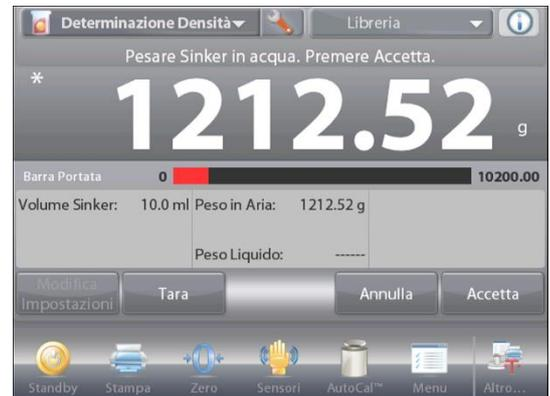
Dopo aver determinato i pesi necessari, la densità del campione viene visualizzata in **g/cm<sup>3</sup>** (insieme al peso in aria e nel liquido) sulla schermata dell'applicazione.
