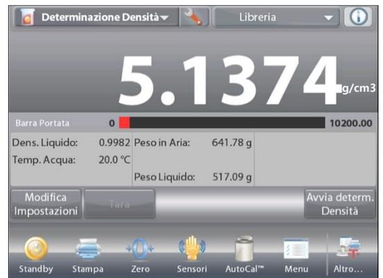
Dopo aver determinato i pesi necessari, la densità del campione viene visualizzata in g/cm3 (insieme al peso in aria e in acqua) sulla schermata dell'applicazione.
