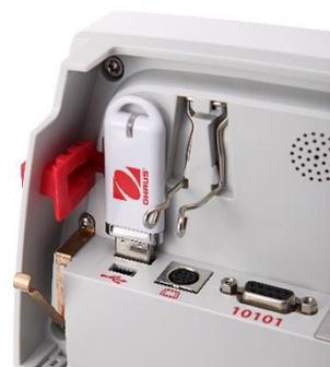
Connessioni di interfaccia sul retro del terminale.
