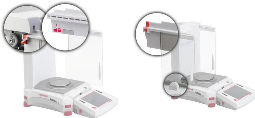
Posizionare lo sportello in vetro scorrevole. Aprire la linguetta di blocco (superiore), inserirla nella scanalatura e farla scorrere all'interno della scanalatura inferiore. Chiudere la linguetta di blocco.
