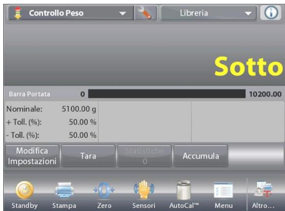
Schermata iniziale **CONTROLLO PESO** con il display impostato a **Controlla stato**
