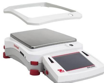
**Nota:** è possibile utilizzare la bilancia senza scudo per correnti d'aria. Tuttavia, a seconda delle condizioni dell'ambiente, i risultati visualizzati possono essere lievemente meno stabili.
