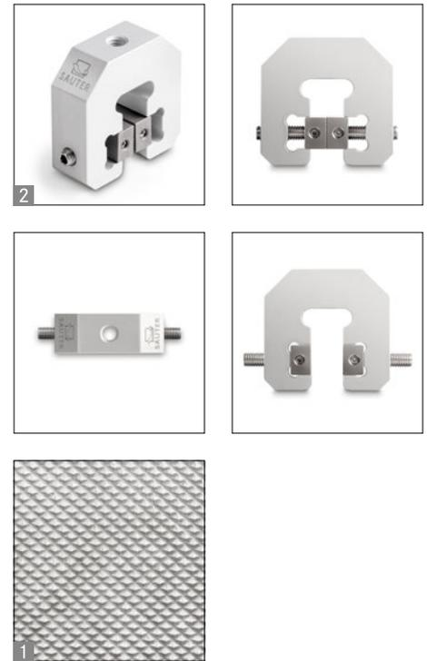
Pince de mesure de force universelle à réglage rapide pour essais de traction et de compression pour une gamme de force jusqu'à 500 N
