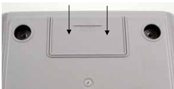
⇒ Установить на место балку пластины весов и пластину весов
