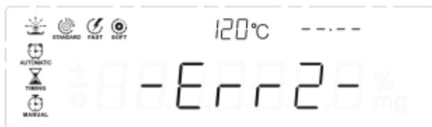
Err-2: Temperatura de secagem muito baixa; ajustar temperatura > 40°C.
