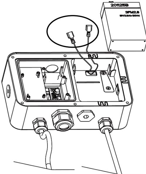
2. Dévissez les deux vis du couvercle de scellement (entouré), retirez le couvercle, puis retirez la première couche du boîtier intégré.
