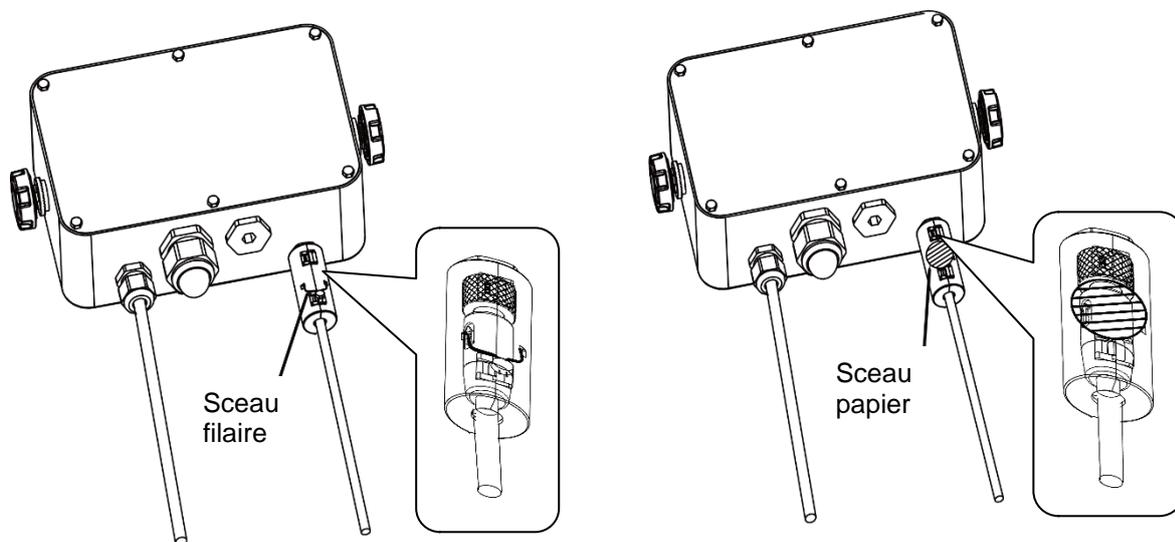
Figure 5-10. Scellage i-DT33XW (câble de raccordement avec connecteur et sans module de mémoire)
