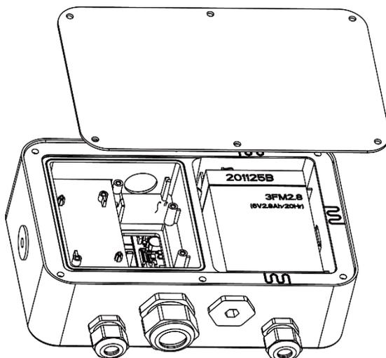
4. Fermez le boîtier et réinstallez les boulons après avoir effectué les connexions internes.
