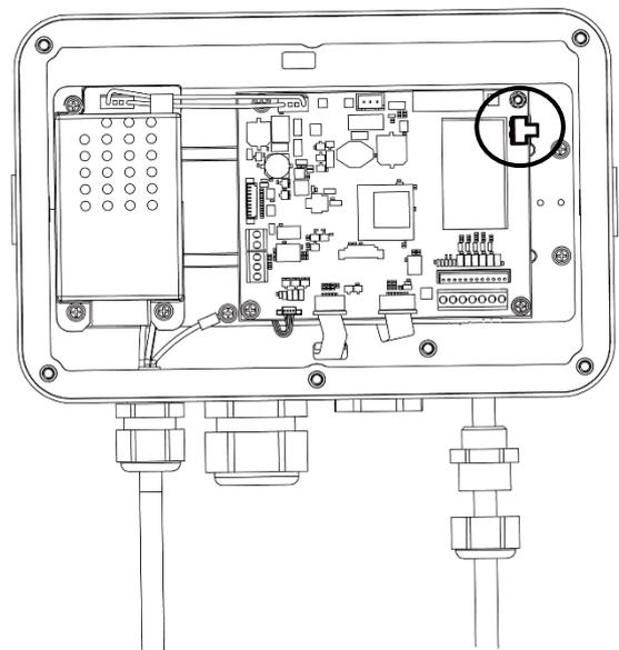
Figure 5-2 Emplacement du commutateur de sécurité (S1), i-DT33XW
