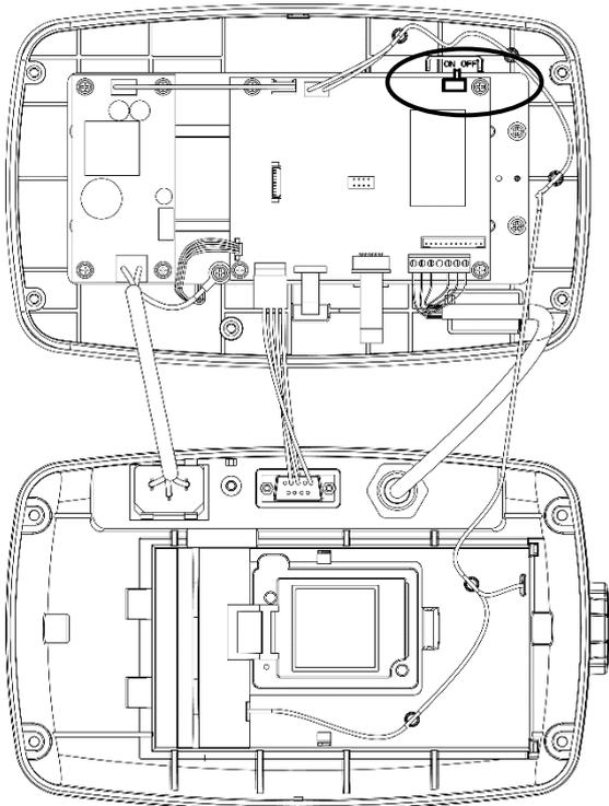
Figure 5-1 Emplacement du commutateur de sécurité (S1), i-DT33P
