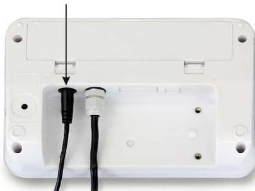
Tomada do transformador
