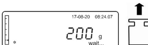
⇒ Depois de fazer o ajuste, a balança mudará automaticamente de novo para o modo de pesagem.
