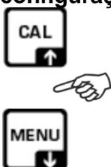
Confirme a seleção do ponto do menu pressionando o botão **PRINT**, a configuração atual será exibida. Após cada pressão dos botões de navegação  $\updownarrow$ , a próxima configuração será exibida.
