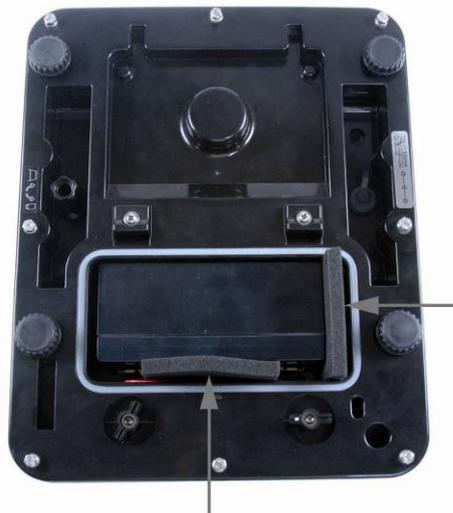
⇒ Colocar la batería de modo que se impida su movimiento (bloquearla con la espuma).
