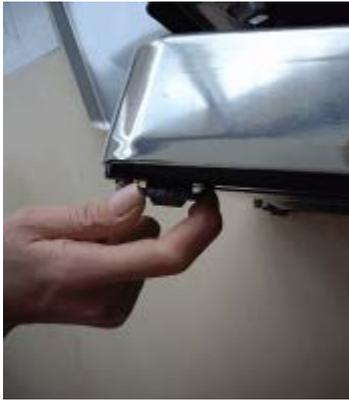
Poner la balanza en posición horizontal usando las patas con tornillos. La burbuja de aire del nivel ha de estar centrada.
