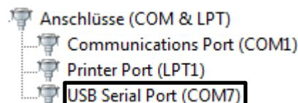
Bei modernen Geräten ist der für den Wägetransmitter notwendige USB Treiber bereits vorinstalliert. Wird das System nicht automatisch erkannt, so erhalten Sie den korrekten Treiber im Bereich Downloads auf <http://www.kern-sohn.com>.
