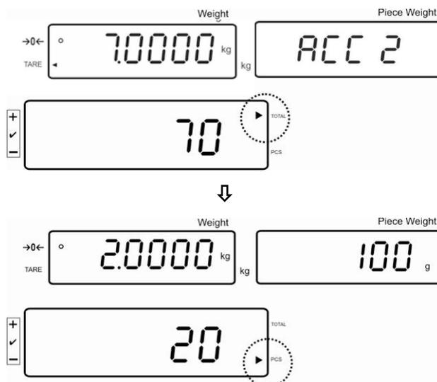
⇒ Occorrendo, sommare il nuovo materiale pesato in modo descritto sopra. Fra le singole pesate bisogna alleggerire il sistema di pesatura.
