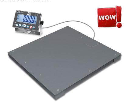
Báscula con plato de pesaje atornillado (IP67) e indicador de acero inoxidable (IP68), con aprobación de homologación [M]
