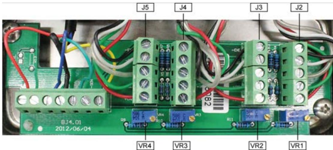
La cellule de pesée 3 est ajustée sur le potentiomètres VR1 et VR2.
