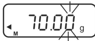
Mantener presionada la tecla **SET** hasta que aparezca la indicación para configurar el límite inferior "L.SET". El ajuste actual. p. ej. "70.00 g" parpadea.
