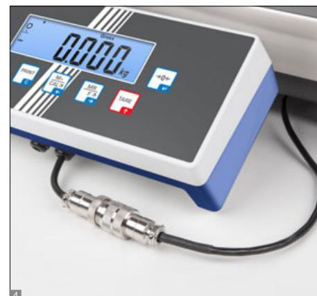
4 Prise d'homologation, permet de séparer l'afficheur et la plateforme sur les balances homologuées sans perdre l'homologation, par exemple pour intégration rétrospectivement de la balance dans une table d'emballage et d'expédition, un cadre de fosse etc.
