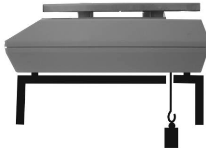
1. ábra: A mérleg előkészítése függesztett mérésre
