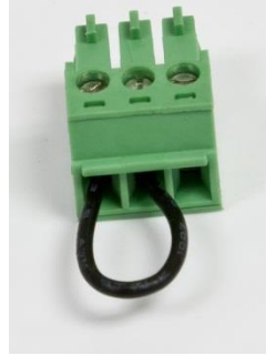
Abbildung 5-4: Drahtbrücke zwischen COM1-Sende- und Empfangsklemmen
