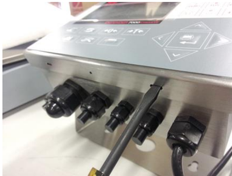
Abbildung 1-2: Öffnen des Gehäuses für raue Umgebungen
