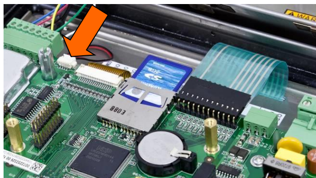
Abbildung 5-7: Einführen der SD-Speicherkarte
