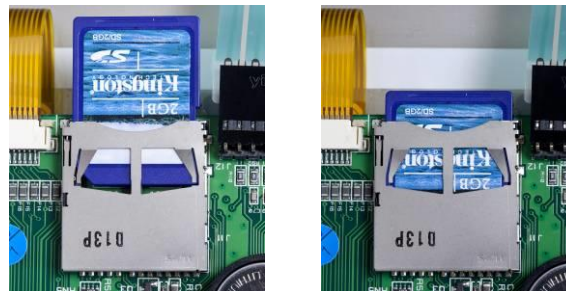
Abbildung 1-10: SD-Karte in den SD-Sockel schieben (links); SD-Karte installiert
