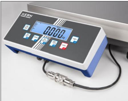
Eichstecker, ermöglicht bei geeichten Waagen das Trennen von Auswertegerät und Plattform ohne die Eichung zu zerstören, z. B. für einen nachträglichen Einbau der Waage in einen Pack- und Versandtisch, Grubenrahmen etc. Bitte beim Kauf der Waage mitbestellen, siehe Zubehör
