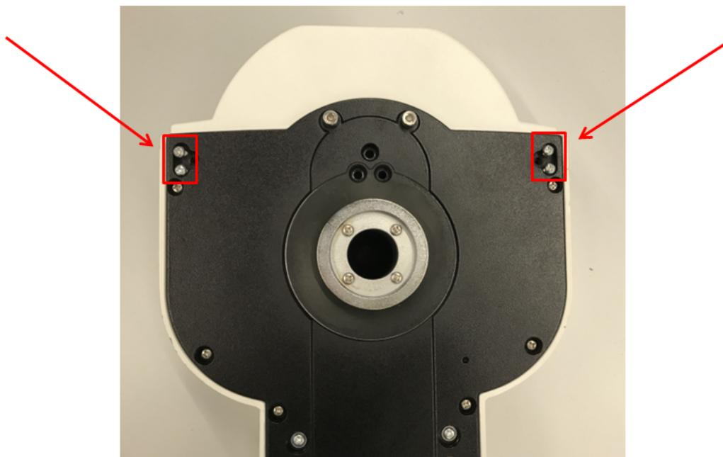
Um das Filtrerrad nun komplett aus dem Gehäuse nehmen zu können, müssen die 3 Schrauben in der Mitte der Unterseite gelöst werden.
