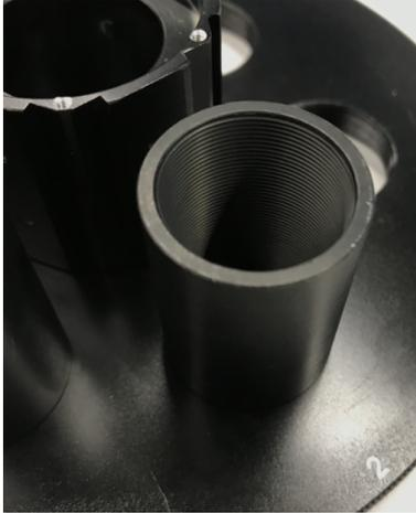
Den schwarzen Metall-Zylinder an der gewünschten Montage-Position entfernen (abschrauben)
