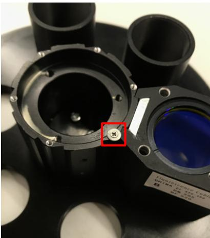
Filterwürfel an Schiene aufstecken und mit Schraube (inkl. Unterlegscheibe) sichern (siehe rote Markierung im Bild links)
