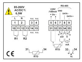
RS-485 85-260V +24V /100mA GND 6,5W DATA + Uo DATA + N 1 2 3 4 5 6 7 8 9 10 11 12 13 14 15 31 32 33 34 35 OC2 mV أصال ŔTD 33 CE ŔTD TC
