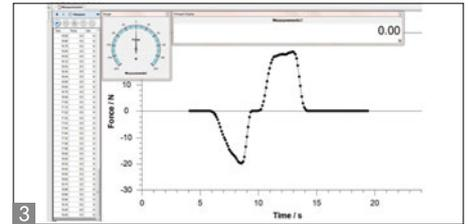
Dynamomètre pour mesures de force de traction et de compression
