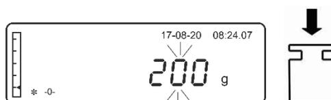
⇒ Mientras parpadea la indicación colocar con cuidado la pesa de ajuste en el centro del plato. El valor parpadeante se fija.
