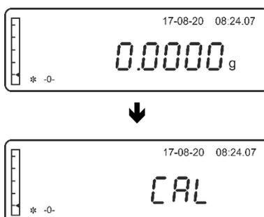
⇒ Esperar la aparición, parpadeando, del valor de masa de la pesa de ajuste.
