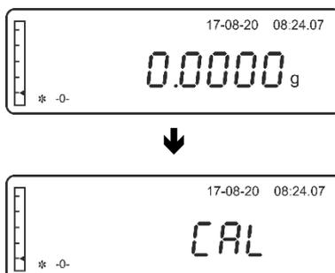
⇒ Aspettare la visualizzazione del valore lampeggiante di massa del peso di registrazione richiesto.
