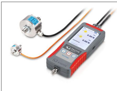
Misurazione simultanea su un massimo di quattro canali. Sono disponibili opzionalmente sensori esterni con memoria dati del sensore
