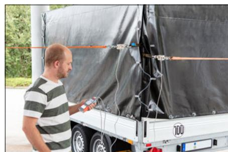
Misurazione di forze in diverse direzioni di trazione o compressione possibile con un solo dispositivo di misurazione
