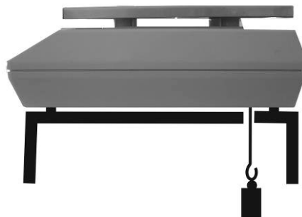
Billede 1: Forberedelse af en vægt til vejning under gulvet
