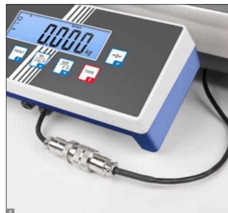
**4** Spina di omologazione, nelle bilance omologate consente di staccare l'apparecchio indicatore dalla piattaforma senza danneggiare l'omologazione, p. es. per il montaggio successivo della bilancia in un tavolo di imballaggio e spedizione, un'intelaiatura per fossa ecc.
