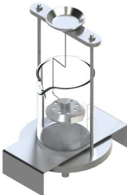
Ilustr.: Kit para cálculo densimétrico KERN YDB-01 com a cesta de mergulho para corpos sólidos flutuantes instalada.
