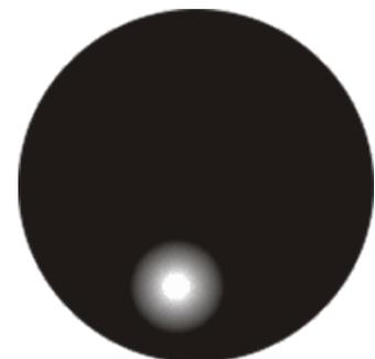
3. Réglez le condensateur en hauteur jusqu'à voir apparaître une image nette du diaphragme de champ dans le champ visuel. Sur certains microscopes, le condensateur peut se soulever trop haut et entrer en collision avec la lame. Un peu de prudence s'impose donc.
