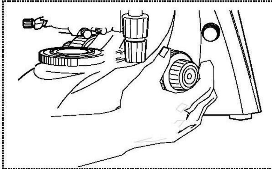
Le moyen le plus simple est de régler au préalable la platine (également à l'aide de la vis macrométrique) juste en dessous de l'objectif, puis de la descendre lentement. Dès qu'une image, même floue, est visible, réglez la netteté à l'aide de la vis macrométrique uniquement.
