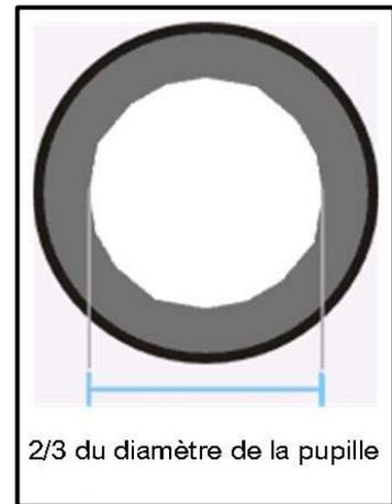
La vue dans le tube sans l'oculaire doit ressembler à peu près à la figure de droite.
