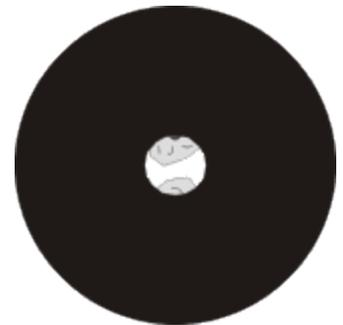
5. Ouvrez le diaphragme de champ jusqu'à ce qu'il disparaisse tout juste du champ visuel. Si nécessaire, recentrez légèrement à l'aide des vis de centrage du support de condensateur.
