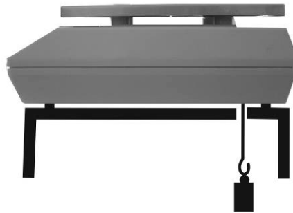
Fig. 1: Preparazione della bilancia per pesatura da sotto la bilancia
