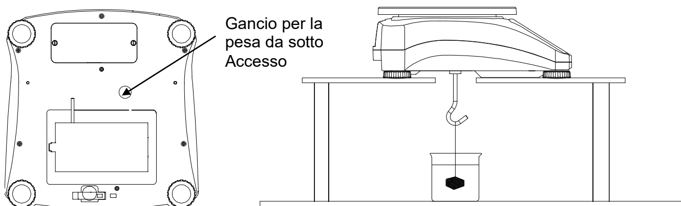
Figura 4-1. Impostazione del gancio per la pesa da sotto
