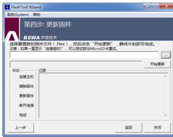
**Étape 4** : Appuyez d'abord sur le bouton dans le coin supérieur droit pour sélectionner le firmware, puis appuyez sur le bouton **Update** pour lancer le programme. L'ensemble de la procédure prend 3 à 4 minutes.
