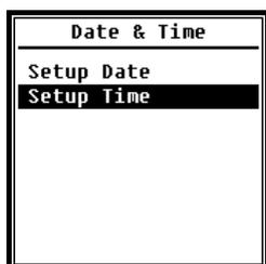
Dans le menu **Date & Heure**, l'heure RTC du sonomètre peut être réglée. Appuyez sur les **touches fléchées <▲>** , <▼> pour sélectionner.
