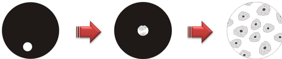
2. Mit der Aperturblende den optimalen Kompromiss aus Kontrast und Auflösung für das mikroskopische Bild einstellen. Für das Objektiv mit der niedrigsten Vergrößerung muss ihr Einstellring fast ganz bis zum Anschlag gegen den Uhrzeigersinn gedreht sein, damit die Aperturblende eine eher geringe Öffnung aufweist.
