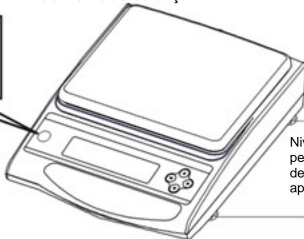
Nivelar a balança através dos pezinhos reguláveis até a bobina de ar na niveladora ficar na faixa apropriada.
