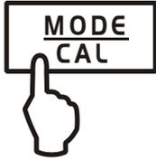
⇒ En el modo de pesaje presionar repetidamente la tecla **MODE** hasta que aparezca parpadeando el valor del „100%”.
