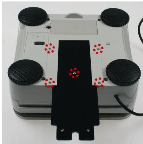
Desatornillar los tornillos marcados para desmontar la placa de montaje. A continuación, colocar el panel de manejo por separado.
