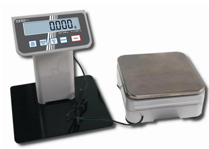
Colocar la balanza de manera que asegure que el plato esté en una posición horizontal exacta.
