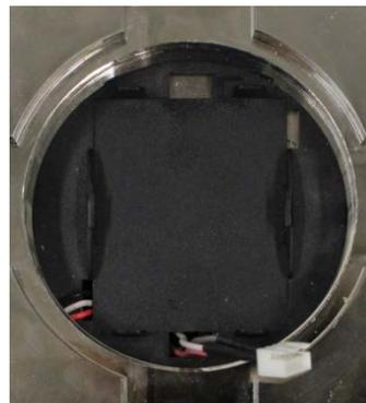
Connecter le câble de la balance au câble de l'accu comme le montre la figure.
