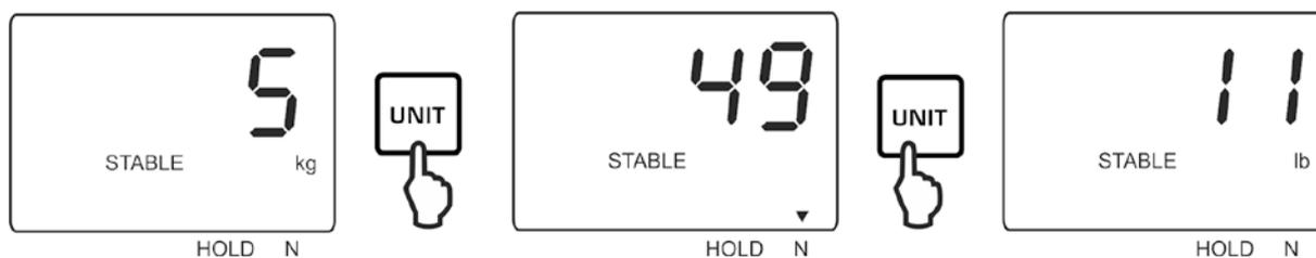
Sous le point du menu „F2 UNT“ peuvent être mises en marche (on) ou à l'arrêt (off) les unités de pesée „N“ et „lb“.
