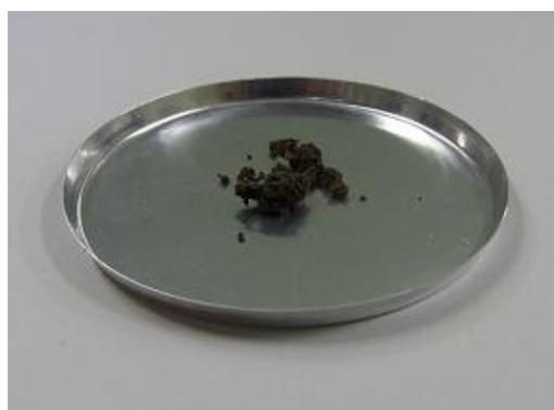
Volumen aufgrund der Trocknung reduziert
