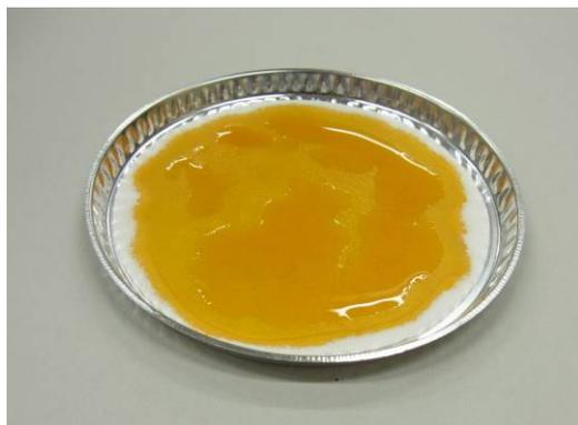
Gleichmäßig auf einem Glasfaserfilter verteilt
