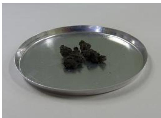
Zerbröckelte Probe auf der Schale verteilt
