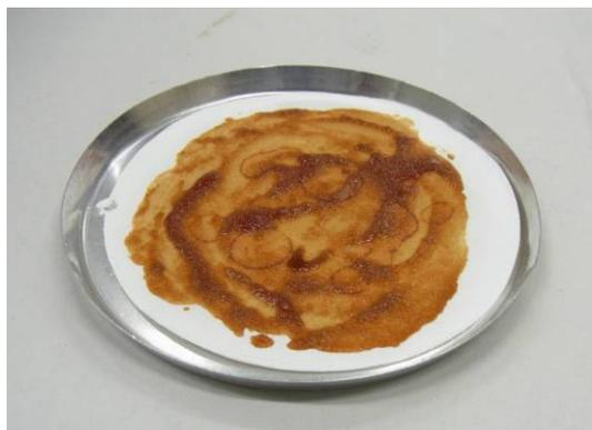
Gleichmäßig auf einem Glasfaserfilter verteilt
