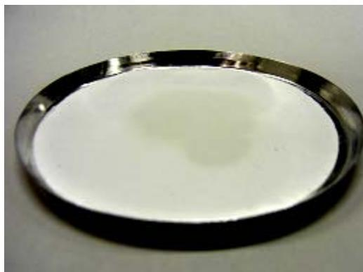
1 g Milch gleichmäßig über einen Glasfaserfilter verteilt
