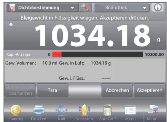
Nachdem die notwendigen Gewichtswerte bestimmt wurden, wird die Dichte der Flüssigkeitsprobe (zusammen mit dem Gewicht in Luft und dem Gewicht in Wasser) in **g/cm<sup>3</sup>** auf dem Anwendungsbildschirm angezeigt.
