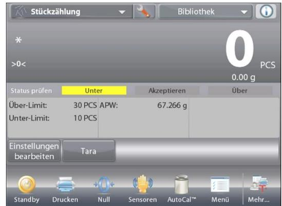
Das standardmäßige (oder letzte) durchschnittliche Stückgewicht (APW) wird angezeigt. Objekte auf die Schale legen, um **Kontrollstatus** (Stückzahl) anzuzeigen.
