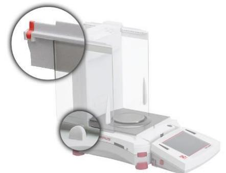
Glastür zum Hineinschieben positionieren. Verriegelungslasche (oben) öffnen; in die obere Rille einsetzen und in die untere Rille schieben. Verriegelungslasche schließen.
