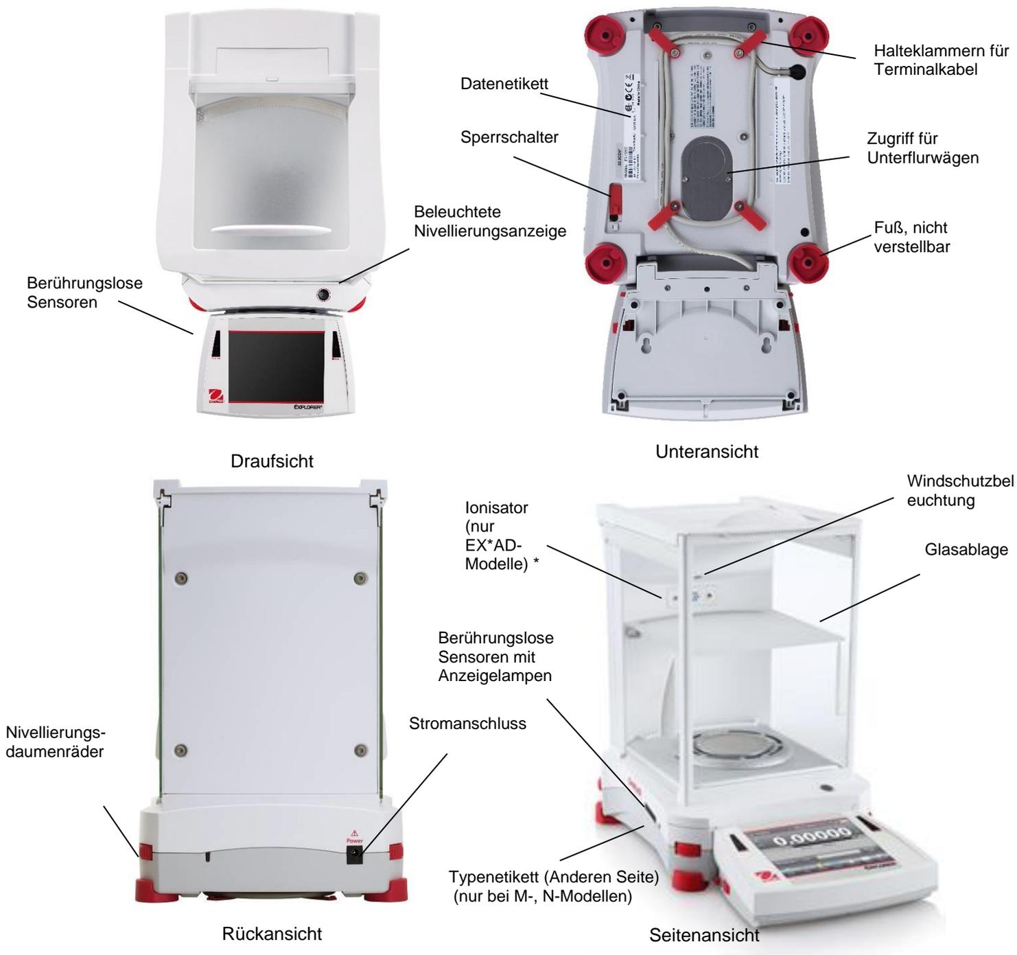
Abbildung 3-1. Explorer Halbmikrowaage
