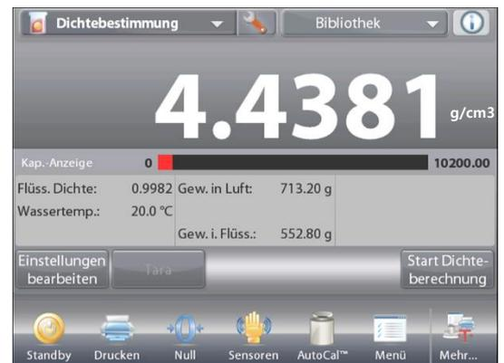
Nachdem die notwendigen Gewichtswerte bestimmt wurden, wird die Dichte der Probe (zusammen mit dem Gewicht in Luft und dem Gewicht in Wasser) in **g/cm<sup>3</sup>** auf dem Anwendungsbildschirm angezeigt.
