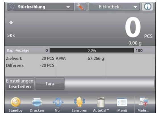
Das standardmäßige (oder letzte) durchschnittliche Stückgewicht (APW) wird angezeigt. Objekte auf die Schale platzieren, um den Füllstatus anzuzeigen.
