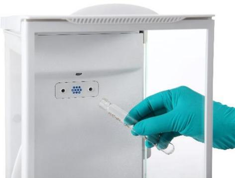
Der Ionisator erzeugt ständig bipolare Ionen durch Gleichstrom-Koronaentladung von positiven und negativen Entladungselektroden und leitet die ionisierte Luft auf den aufgeladenen Körper, um die statische Aufladung zu beseitigen. Die Polarität der erzeugten Ionen ist ausgeglichen, und die statische Aufladung kann unabhängig von der Polarität des aufgeladenen Körpers eliminiert werden.
