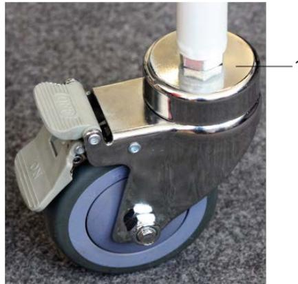
Contrôlez régulièrement si ces écrous (1) sont bien serrés et les freins/roues sont en état de fonctionnement.
