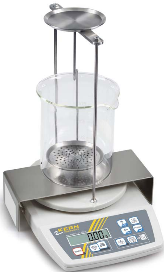
Fig. 1: Bilancia KERN EMB 2000-2V con il kit per la determinazione di densità KERN YDB-02
